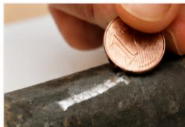
3 Bleirohre sind weich und lassen sich z. B. mit einer Münze einritzen. An der eingeritzten Stelle glänzt dann das blanke Blei.
