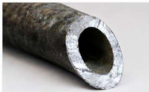
2 Gealterte Bleileitungen sind grau. Im Anschnitt kommt das blanke, glänzende Blei zur Geltung.
